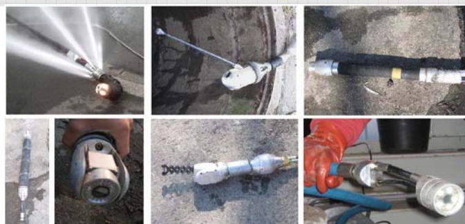
Verschiedene Systeme zur Untersuchung von Anschluss-Leitungen
