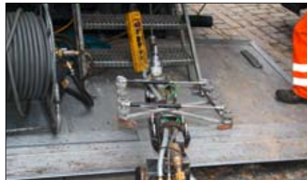
Sonderaufbauten für Fräser im Sonderprofil
